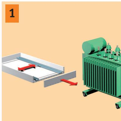
1 T-Seite der Ölauffangwanne lösen und ggf. die Laufschienen an das Spurbreitenmaß des Transformators anpassen.
